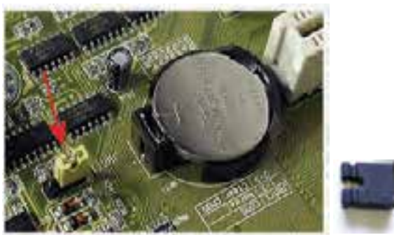
شکل ۱۴-۴ نمونه‌ای از یک اتصال دهنده مخصوص جامپرهای پین‌دار و محل جامپر در برد اصلی
